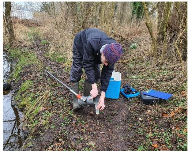
Abbildung 2-5: Durchflussmessung (OTT MF Pro, links) und Probenahme (rechts) an den Zu- und Abläufen des Dümmer Sees
